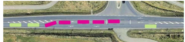
Blockierung des bevorrechtigten Verkehrs durch einen kurzen Abbiegestreifen
